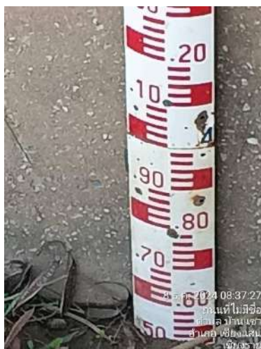
รูปที่ 4 การตรวจสอบระดับน้ำจากบรรทัดวัดระดับน้ำ
