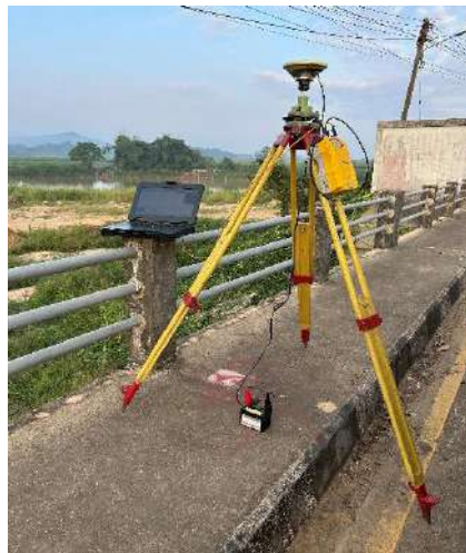
รูปที่ 8 ตรวจสอบความถูกต้องของเครื่องรับสัญญาณดาวเทียม
