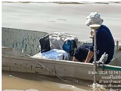
รูปที่ 7 ตรวจสอบความถูกต้องของเครื่องหยั่งน้ำ
